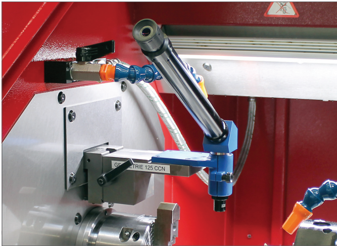
Microscope de mise à zéro Werkzeug-Nullstellung Tools zero setting 0125-60014-000
